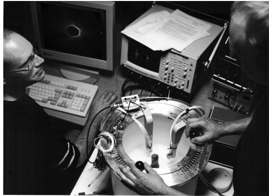
Abb. 3. Versuchsanordnung zur Ultraschall-Computertomographie. Das zu untersuchende Objekt liegt in einem mit Wasser gefüllten Topf und zwei auf einem Ring verfahrenbaren Ultraschall-Wandlerarrays simulieren einen vollständigen Ring von Wandlern.
